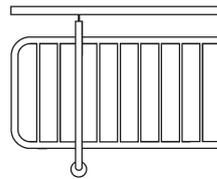
Handlauf und Pfosten  $\varnothing$  42 mm, Rahmen  $\varnothing$  33 mm, Füllstäbe  $\varnothing$  10 mm.
