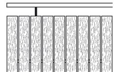
Handlauf 50/30 mm, Pfosten, senkrechte Holzprofile aus nordischer Fichte, lasiert. Diagonale Holzverkleidung möglich.
