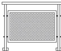
Handlauf  $\varnothing$  42 mm, Pfosten, Winkelrahmen mit Lochblechfüllung in Stahl oder Alu.
