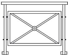
Handlauf 40/30 mm, Pfosten, Winkelrahmen mit vorgesetztem Andreaskreuz, Füllung mit einer Volkkernplatte, Glas oder Holz.
